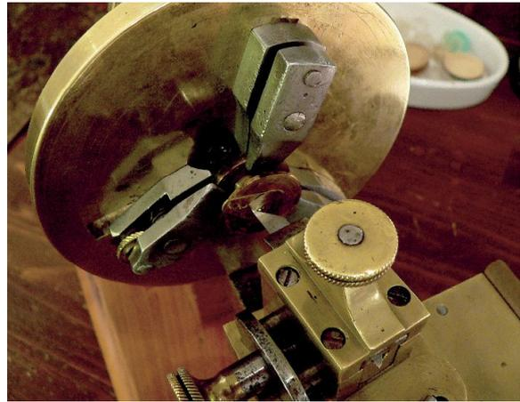
34 Tournage du pont du faux pendule au burin fixe.
